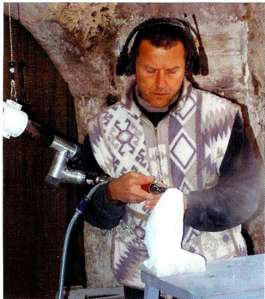
▲► Philippe Bellanger au travail sur un bloc d'albâtre pour reproduire l'Evêque de Brou. L'écran lui indique en temps réel la position de l'outil et l'avancée de son travail.
